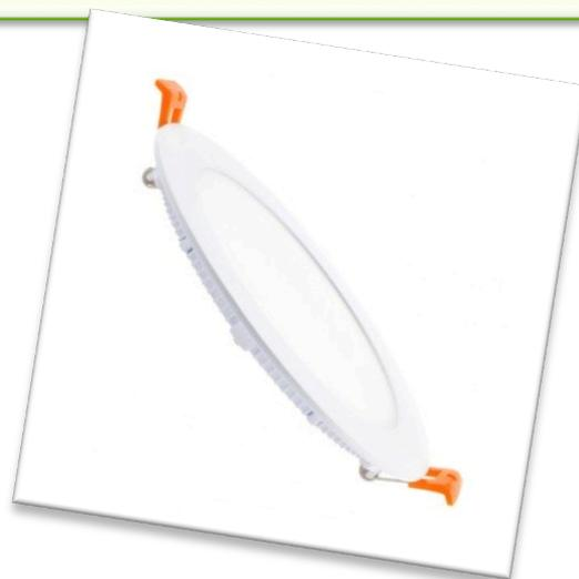
Sa source lumineuse LED SMD 2835 a un rendement de 80 lm/W. Elle est branchée directement à 220-240V AC et n'a pas besoin d'être mis à la terre. Elle peut supporter des fluctuations de tension d'entrée entre 85 et 265V AC. Sa durée de vie est estimée à 30 000 heures.
