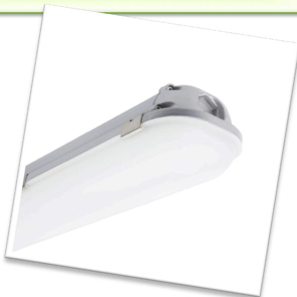
Réglette étanche LED 600mm de conception rectangulaire et 18W de puissance. Il offre à la fois un éclairage optimal et une solution d'étanchéité, grâce à ses matériaux résistant à l'eau, à la poussière et à la corrosion, avec un facteur de protection IP65. Il dispose d'un boîtier en PC et capot en PC. Il est idéal pour remplacer les réglettes classiques de tubes fluorescents de 40W.
